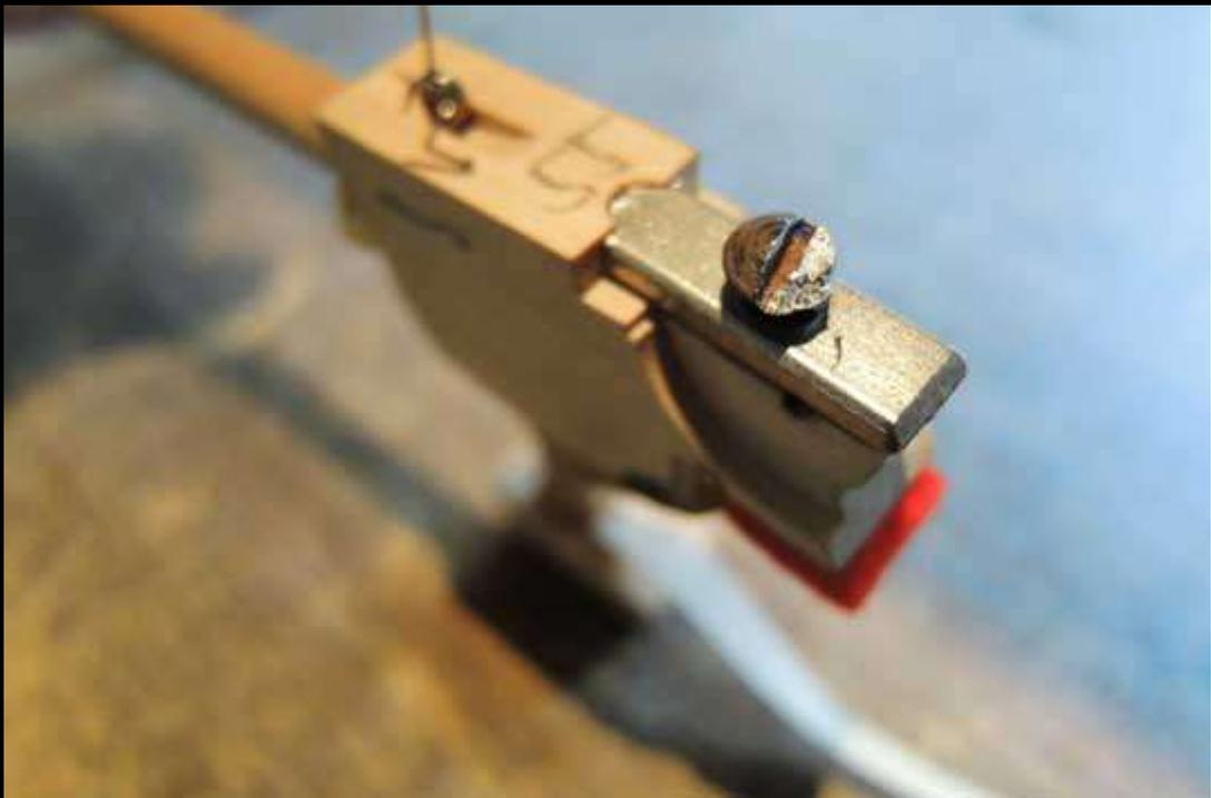
*Eine abgebrochene Hammernuss-Schraube muss erneuert werden*
