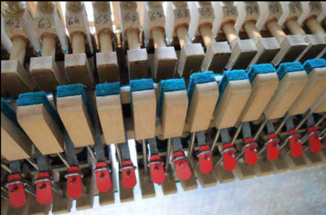
*Mechanik fertig montiert, muss nun reguliert werden*
