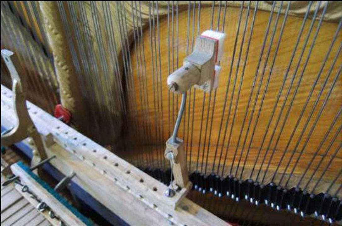
*Einbau des ersten Dämpfers, auf Saiten ausgerichtet*
